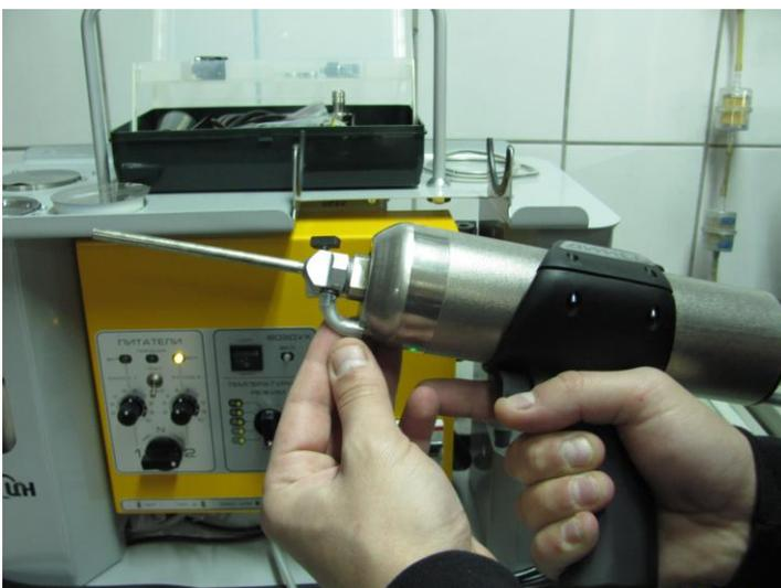
Эффективность напыления плоским соплом СП9 для большинства материалов ниже, чем эффективность напыления круглым соплом СК20.
