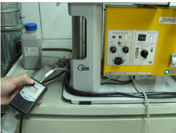
При достаточном разрежении в трубке подачи порошка проверяется участок трассы от порошкового питателя.
