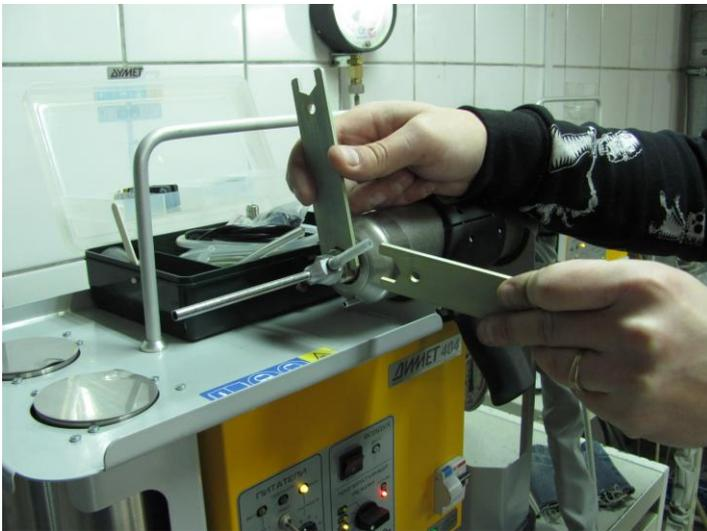
При установке новой шайбы возможно несовпадение позиций штуцера инъекции сопла и стальной порошок трубки на напылителе
