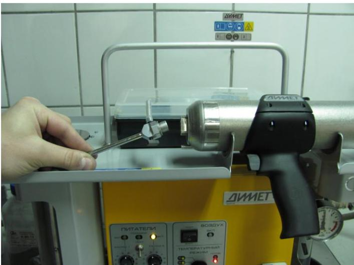
Для замены круглого сопла СК20 на плоское сопло СП9 следует сдвинуть гибкий соединитель с металлической трубки на напылителе и выкрутить сопло из резьбового соединения с напылителем.
