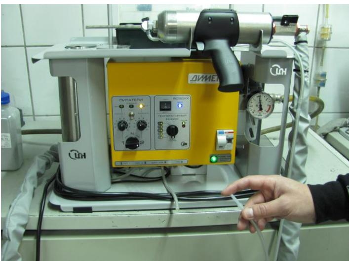
Отсоедините трубку подачи порошка, идущую к напылителю, от трубки переключателя питателей и, включив подачу воздуха в сопло, проверьте разрежение на торце трубки, идущей к напылителю.
