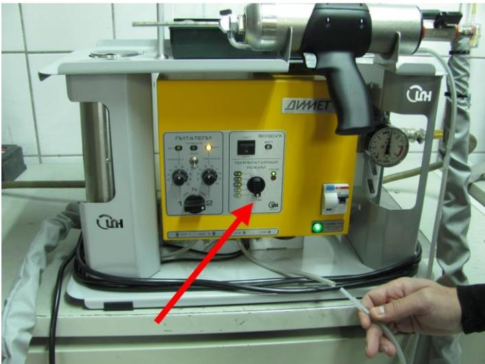
Режим напыления устанавливается дискретно выбором позиции переключателя «Температурный Режим».
