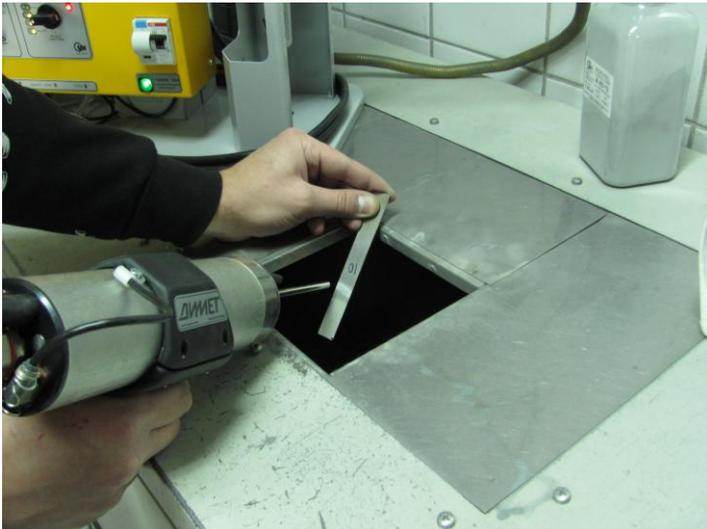
Установить приемлемую скорость подачи порошка можно без проведения специальных измерений. Для этого следует сначала установить ручку регулятора расхода в минимальное положение (например, в положение «1») и напылить в режиме «3» на кусочек металла небольшую полоску, перемещая сопло со скоростью около 1 см/с.
