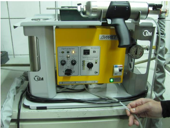
Соедините гибкую трубку подачи порошка, идущую от напылителя, с гибкой трубкой, идущей от переключателя порошка.
