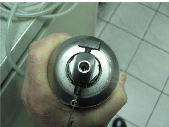
В надёжности прочистки можно убедиться, удалив сопловую вставку. Свободное движение проволоки в канал сверхзвукового сопла указывает на отсутствие засора.
