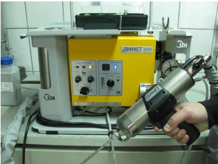
После включения воздушного потока накопленный в нижней части питателя порошок поступает в сверхзвуковое сопло и может перегрузить поток.
