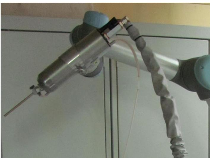
Напылитель без рукоятки более удобно закреплять в держателе устройства при выполнении автоматизированных операций нанесения покрытий.
