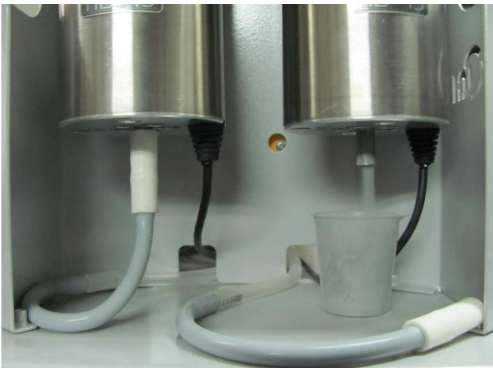
Для проверки правильности установленной скорости подачи порошка можно измерить скорость наполнения мерной чашки, прилагаемой в комплекте. Для этого отсоедините от питателя трубку подачи порошка, подставьте под выход питателя мерную чашку и включите тумблер «Порошок». За 60 секунд наполнение чашки должно составить для порошков
