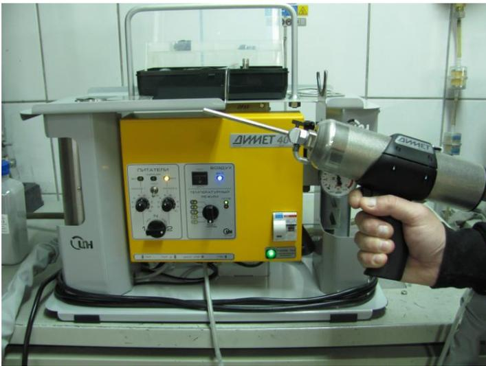
При ручной работе включение подачи воздуха и порошка производится клавишей на съемной рукоятке напылителя.
