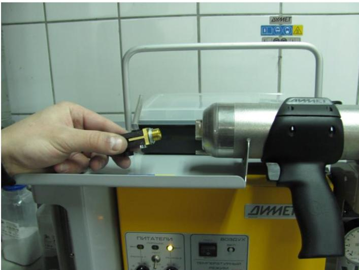
Плоское сопло СП9 из комплекта оборудования вкручивается в резьбовое соединение плотно, но без большого усилия.
