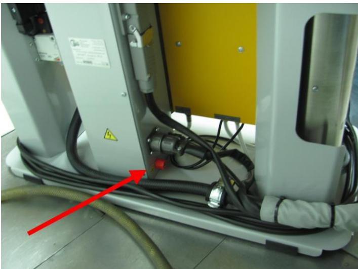
Заземление может быть подведено отдельной шиной к болту заземления на задней стенке аппарата.
