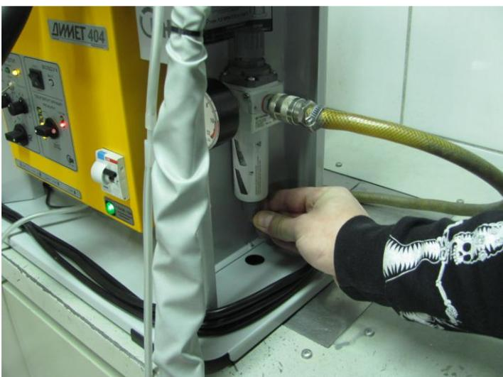
При работе следует регулярно контролировать состояние системы очистки воздуха.
