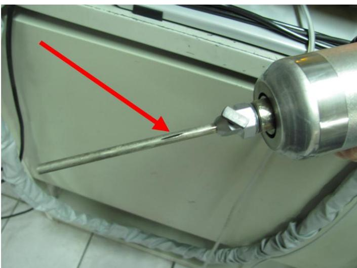
В процессе напыления покрытий и абразивной обработки поверхностей происходит эрозия внутренних стенок сопла. По прохождении через сопло примерно 1,5 - 2 кг порошкового материала в стенке возникает сквозное отверстие.
