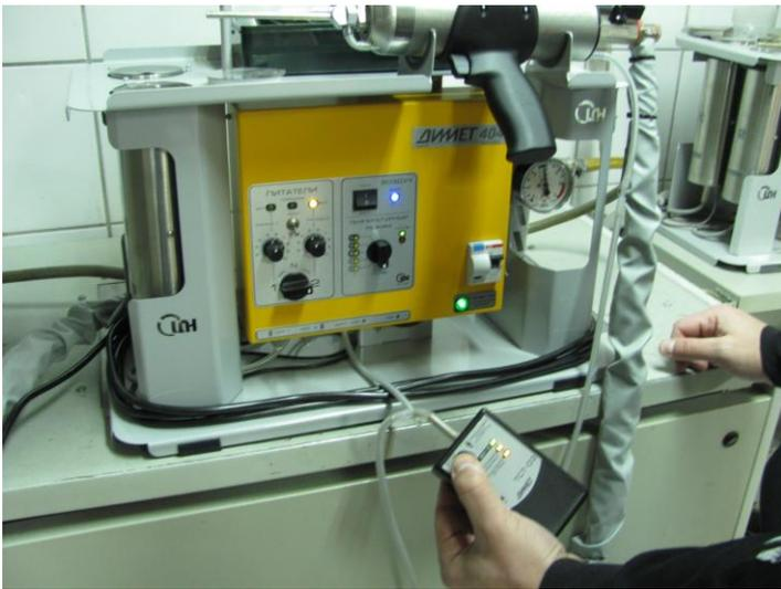
При наличии тестера порошковой трассы состояние трассы проверяется не по наличию разрежения, а по эффективному расходу воздуха, транспортирующего порошок. Проверка эффективного расхода воздуха позволяет выявить наличие сильных сужений трассы и потерю герметичности, которые могут приводить к систематическим забиваниям узла инъекции. Проверка трассы производится при включённой подаче воздуха через сопло.
