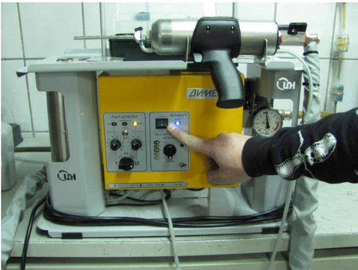
При частичной автоматизации нанесения покрытий включение подачи воздуха выполняется клавишей «Воздух»,
