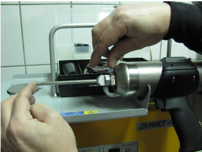
При возникновении сквозного отверстия в стенке сопла надо удалить сменную часть, открутив зажим на сопле, и вставить новый сменный элемент. Затягивайте зажимной винт без приложения усилий, чтобы не деформировать сопло. Сменная часть цилиндрического сопла СК20 поставляется производителем под названием «вставка сменная К6».
