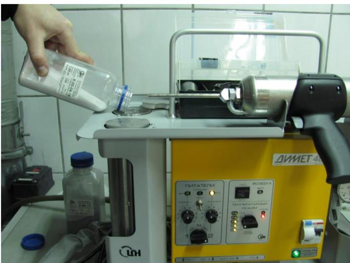
При нанесении толстых покрытий на сталь, чугун и другие твердые материалы, а также в случае необходимости очистки поверхности применяется порошок абразива. Он засыпается в бункер другого питателя.
