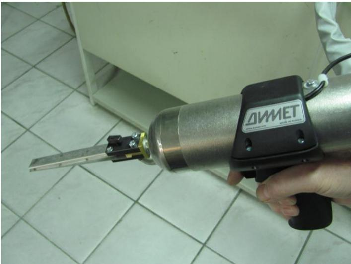
Для нанесения однородных тонких металлических покрытий удобно использовать плоское сопло СП9.
