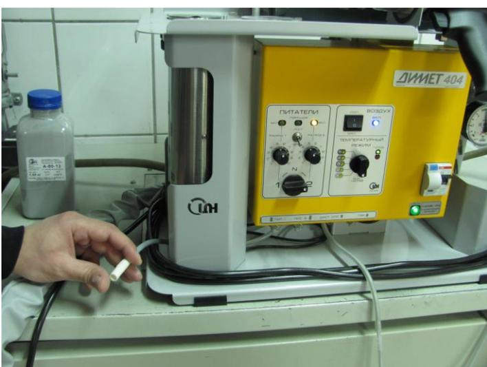
Для проверки всей порошковой трассы следует проконтролировать разрежение непосредственно на конце трассы, примыкающем к порошковому питателю.
