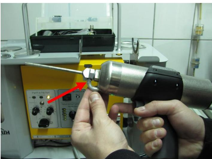
При восстановлении соединения будьте внимательны. Не оставляйте изломов или перегибов гибкого соединителя.
