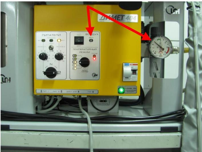
Датчик давления обеспечивает защиту напылителя от перегрева. При снижении давления ниже 4 атмосфер нагрев воздуха в напылителе автоматически блокируется. Синий индикатор «Воздух» при этом гаснет.
