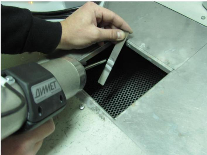
Если толщина нанесенного покрытия составляет менее 0,5 мм, то можно добавить величину расхода (увеличить на 0,5 – 1 деление величину регулировки расхода порошка) и снова провести напыление.
