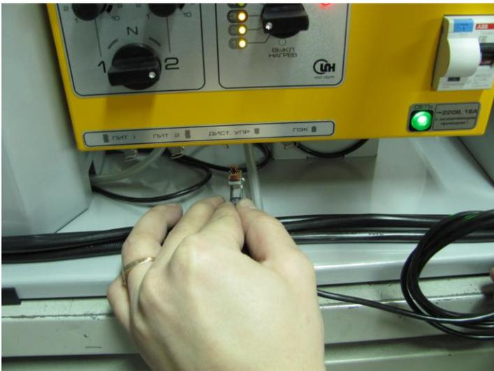
Разъём дополнительного кабеля подсоединяется к розетке «Дист. Упр.» на нижней части панели.
