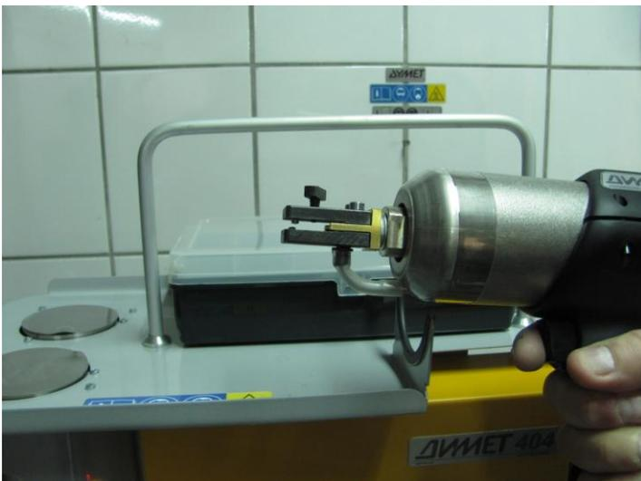
При соединении гибкого соединителя с трубкой напылителя не допускайте заломов и перегибов соединителя.
