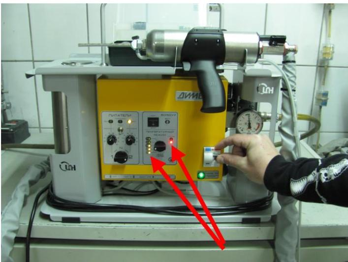
При переводе переключателя режима в положения «1» - «5» на панели загораются индикаторы выбора режима и красный индикатор готовности напылителя к нагреву воздуха.
