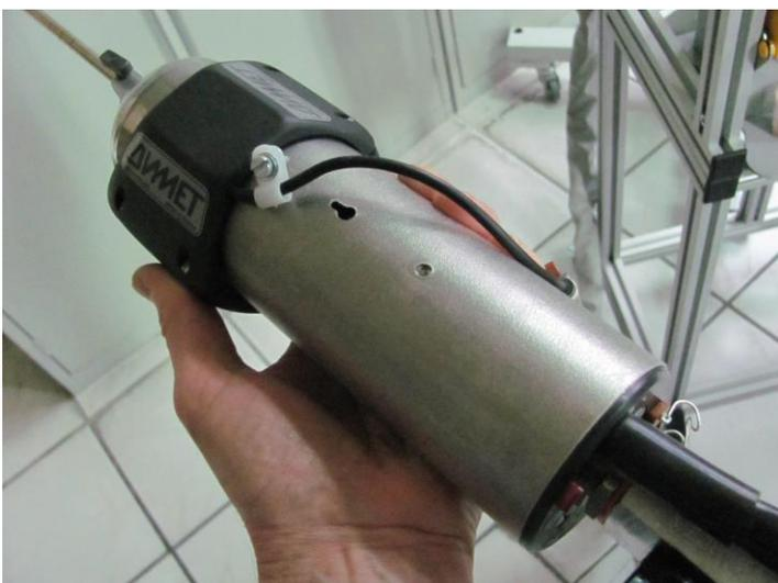
Рукоятка сдвигается с корпуса напылителя.
