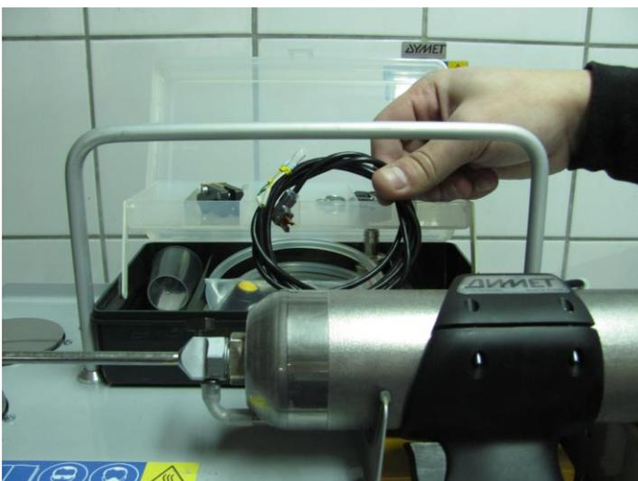
Включение подачи воздуха и порошка при автоматизации процесса возможно посредством замыкания контактов внешним устройством через дополнительный кабель из комплекта поставки.
