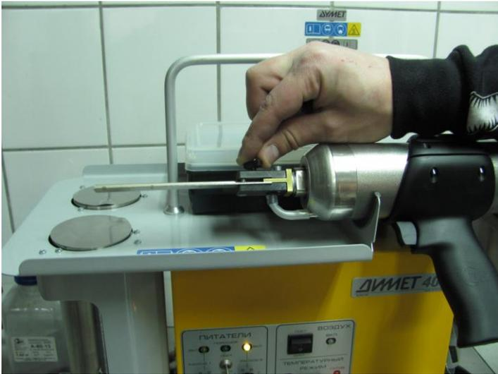
Затяните зажимной винт без больших усилий, так, чтобы не продавить сопловую вставку.
