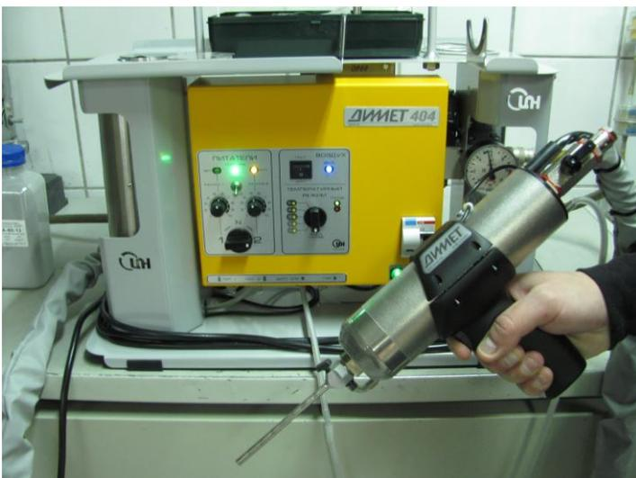
При нажатии клавиши до упора включается порошковый питатель и производится подача порошка в сверхзвуковое сопло.
