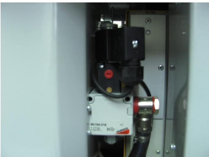
После разблокировки электропитания механический регулятор воздушного клапана надо перевести в исходное состояние.
