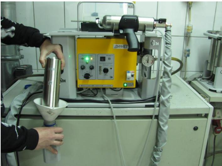
Если порошковая трасса и узел инъекции сопла функционируют нормально, но порошок не поступает в сопло, то засор следует искать в порошковом питателе.
