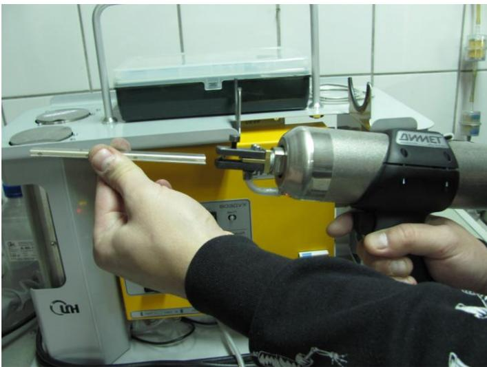
Ресурс сменной части сопла СП9 – 0,8 – 1,2 кг порошкового материала.
