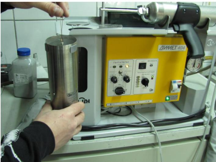
Плавно без рывков вытяните за проволочную петлю клапан порошкового питателя.
