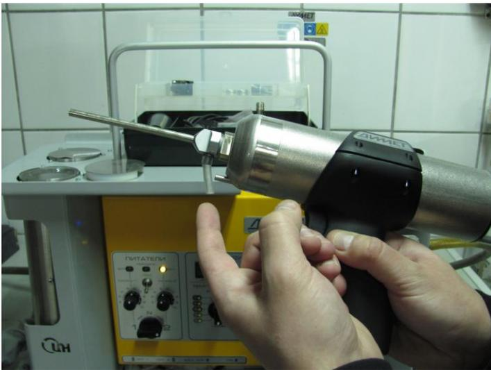
Если разрежение в порошковой трассе отсутствует, проверьте разрежение на входе в узел инъекции сверхзвукового сопла.
