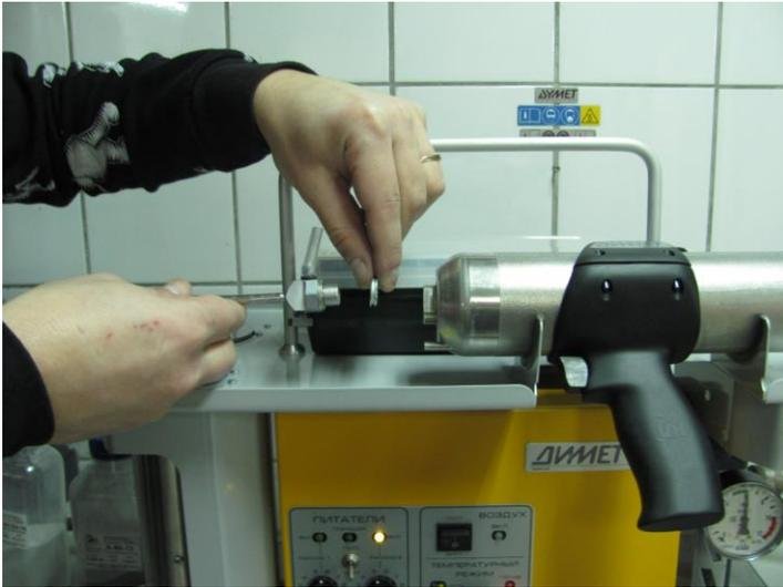
Позиция сопел СК20 и СП9 в резьбовом соединении регулируется сжимаемой шайбой. В состоянии поставки толщина шайбы на сопле отрегулирована.
