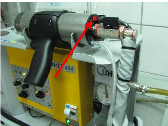
При включении воздушного потока загорается красный индикатор, расположенный на торце напылителя, и воздух нагревается.
