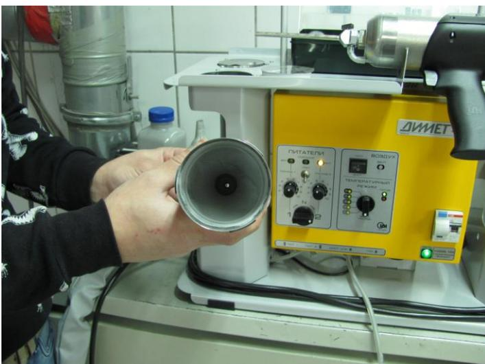
При снятом с выходного штуцера гибком соединителе питатель без клапана должен просматриваться насквозь.
