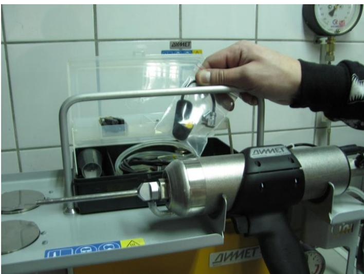
На корпусе напылителя вместо рукоятки может быть закреплена кнопка включения порошка.
