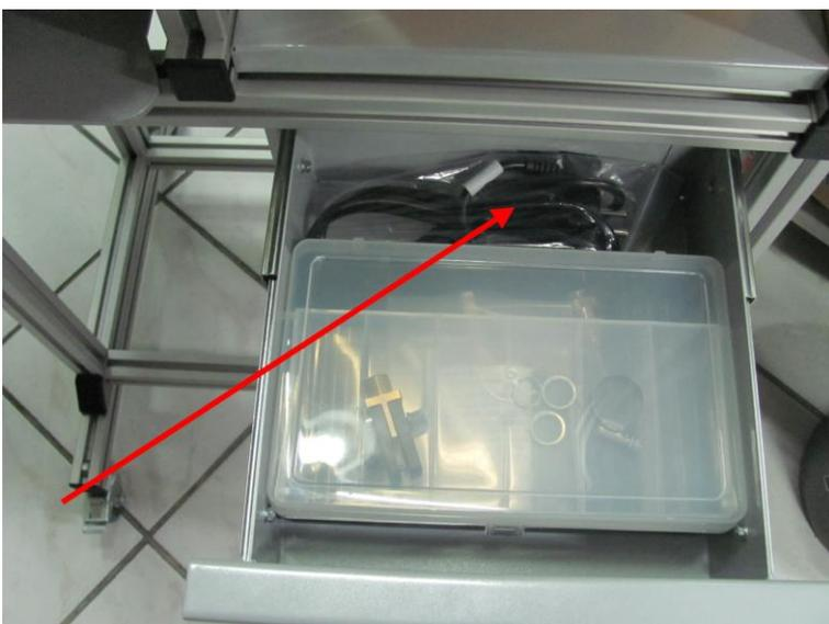
Для подключения к сети снятого со стойки блока управления питателем используется сетевой провод из комплекта поставки.
