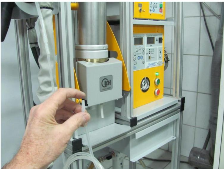
Транспортировка порошка от питателя к напылителю происходит по порошковой трассе, выполненной из силиконовых трубок, в результате перепада давления, создаваемого при подаче воздуха в сверхзвуковое сопло.
