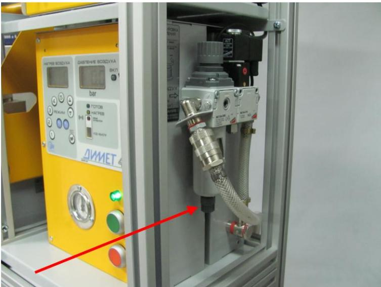
Для стабильной работы оборудования необходимо контролировать состояние системы очистки воздуха.
