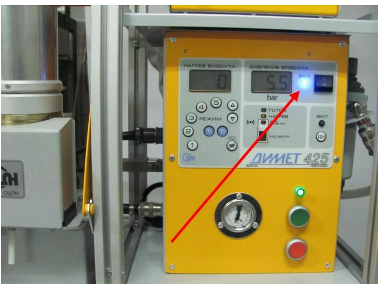
При давлении воздуха, направляемого в напылитель, выше 4 атмосфер загорается синий индикатор «ВКЛ».
