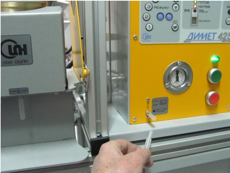
В моделях ДИМЕТ-425 с 2020 года устанавливается датчик разрежения.
