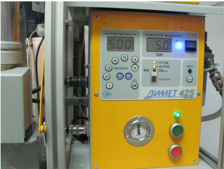
Режим напыления выбирается исходя из требований к процессу и к качеству покрытия. Применимым в большинстве случаев является режим «3». При снижении номера режима возрастает качество покрытия, но снижается эффективность напыления. При увеличении номера режима растет эффективность напыления, но снижается качество покрытия.
