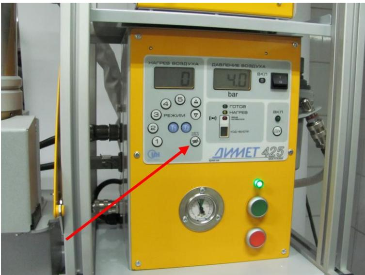
Нажатие кнопки «нагр. откл.» позволяет отключить нагрев сжатого воздуха.
