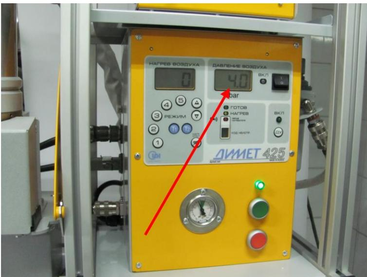
Давление воздуха, направляемого в напылитель при полном расходе воздуха через сопло должно быть не меньше 5 атмосфер ( **5 bar** на внешней черной шкале манометра, установленного на аппарате).
