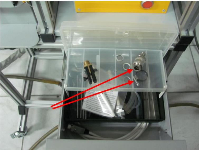
Для подключения используется пневматический разъем с хомутом крепления на шланге из комплекта поставки.
