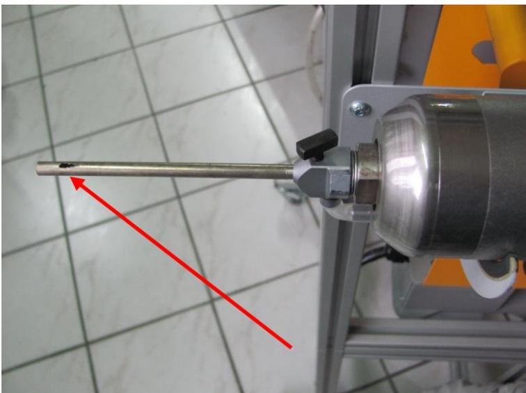
Интенсивность и распределение участков износа стенок сопла зависит от рабочего давления воздуха.
