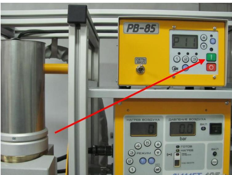
Для визуального контроля вращения устройства дозирования надо нажать и удерживать зелёную кнопку на панели блока.
