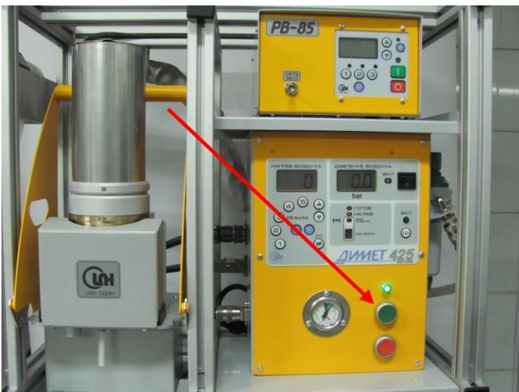
Нажатием зелёной кнопки производится включение установки.
