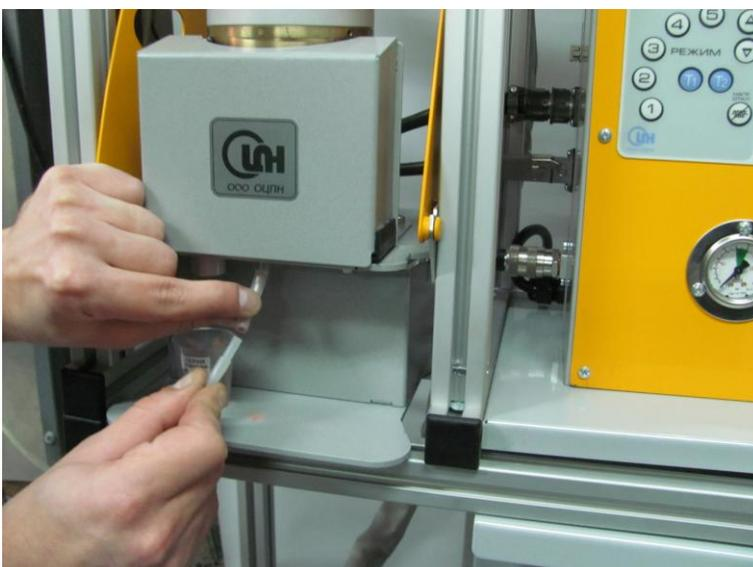
Для транспортировки порошка от питателя к напылителю необходимо соединить гибкую трубку подачи порошка, идущую от напылителя, с гибкой трубкой, выходящей из питателя.
