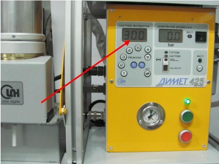
Режим напыления устанавливается дискретно выбором соответствующей кнопки на панели.
