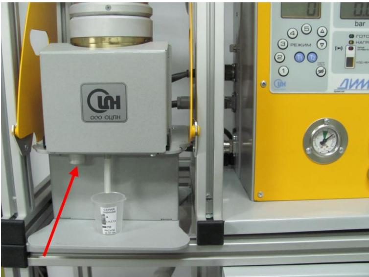
Если питатель работал при забитом тракте подачи порошка или без включения подачи воздуха, то возможно накопление порошка в стабилизаторе питателя.
