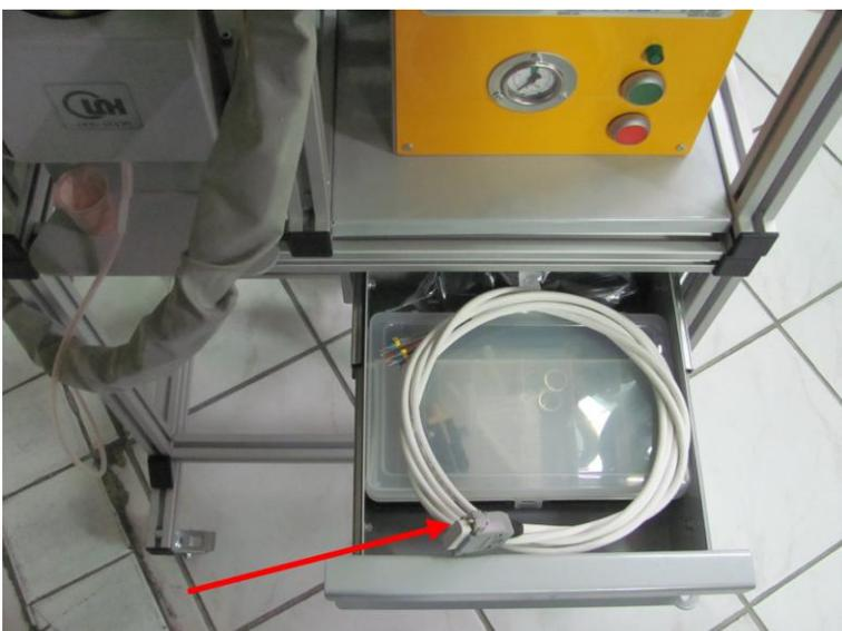
Для включения установки в совместную с манипулятором систему управления можно использовать кабель дистанционного управления, поставляемый в комплекте.
