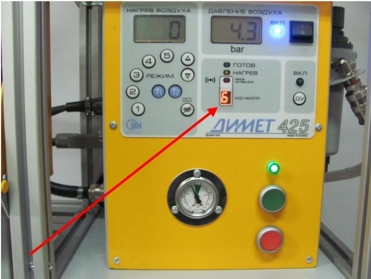
При давлении воздуха, направляемого в напылитель, ниже 4,5 атмосфер на панели появляется индикация ошибки.
