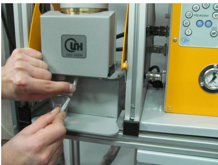
После очистки стабилизатора питателя следует проверить наличие разрежения в тракте подачи порошка при включении воздуха и затем подсоединить тракт к питателю для продолжения работы.
