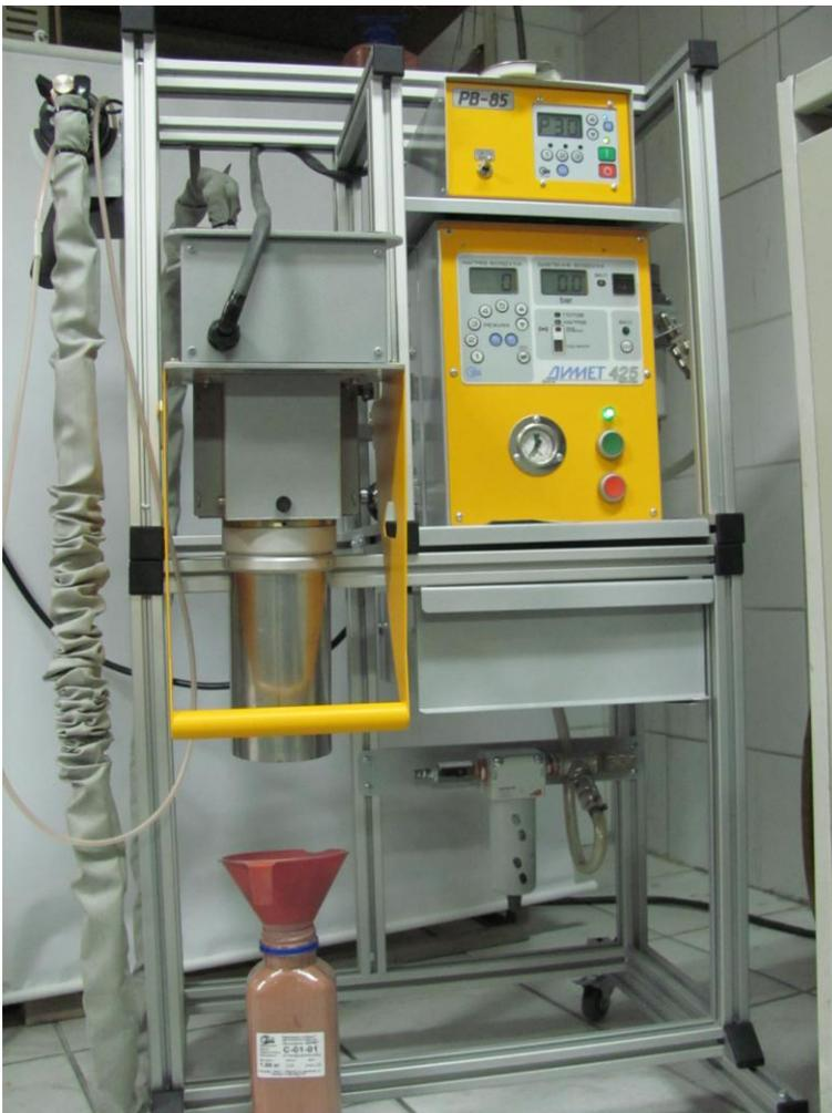
Включение работы питателя на максимальном режиме в перевёрнутом состоянии позволяет быстро удалить весь загруженный порошок.
