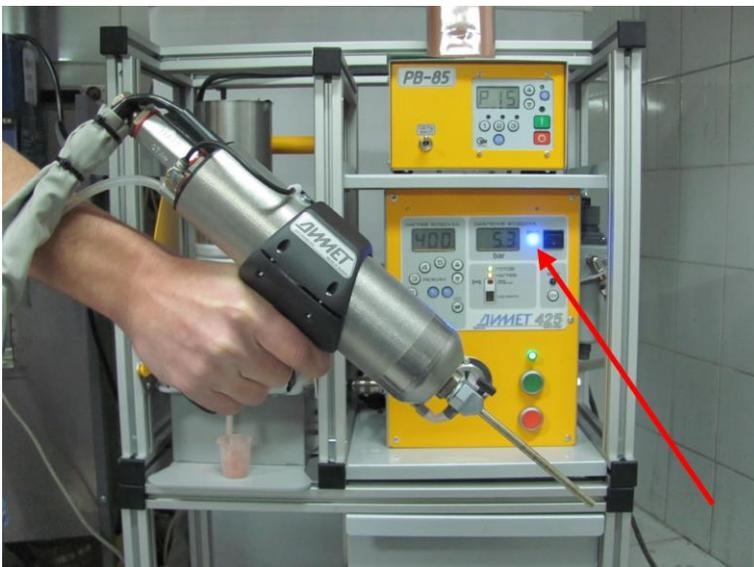
При частичном нажатии клавиши на рукоятке включается подача воздуха, что индицирует синий светодиод на панели.
