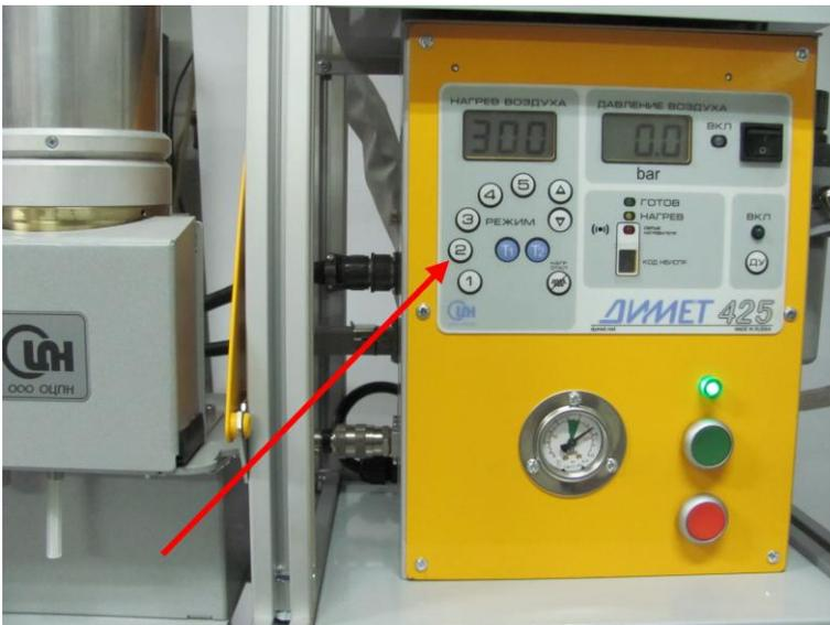
Пять предустановленных режимов «1» - «5» соответствуют типовым режимам напыления оборудования ДИМЕТ.
