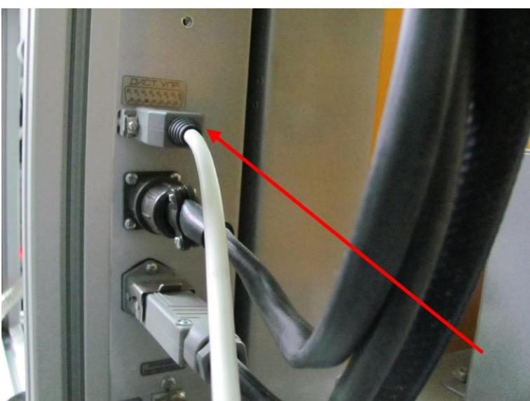
Кабель дистанционного управления подключается к разъёму «ДИСТ.УПР.» на боковой панели блока управления ДИМЕТ-425.
