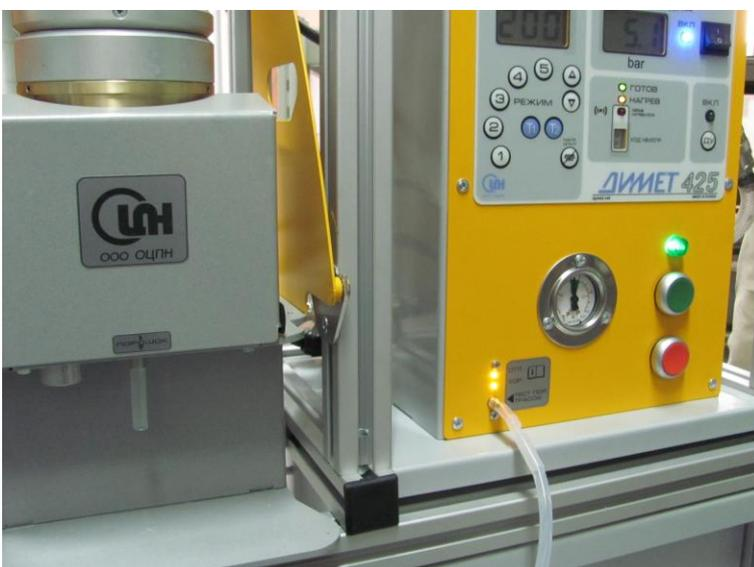
Использование рекомендуемого рабочего давления 5,0 – 6,0 атмосфер, длины порошковой трассы менее 2 м и сверхзвуковых сопел типа СК обеспечивает оптимальные условия функционирования оборудования ДИМЕТ-425.
