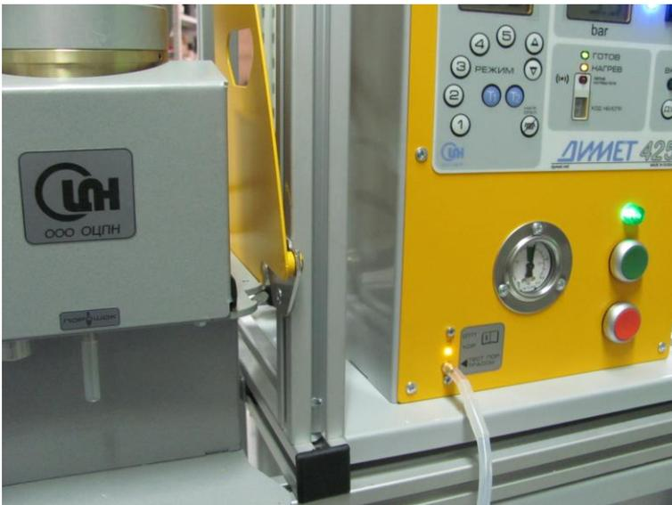
При наличии в порошковой трассе достаточного для транспортировки порошка разрежения должен загореться индикатор датчика разрежения.
