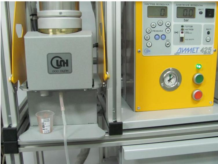
После подключения порошковой трассы к питателю включение подачи порошка должно производиться только при наличии потока воздуха через сопло.
