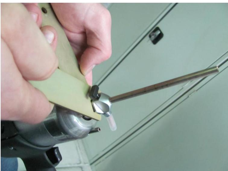
Для откручивания сопла используются ключи из комплекта поставки.
