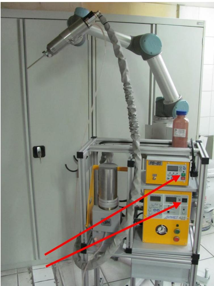
Управление включением воздуха и включением подачи порошка можно выполнять с панелей блоков управления.
