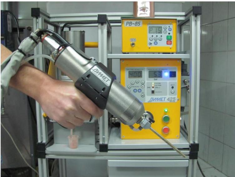
При ручной работе следует сначала нажимать клавишу на рукоятке до половины и дождаться загорания индикатора «ГОТОВ», затем направить поток на объект напыления и нажать клавишу до упора. После окончания процесса напыления следует отпустить клавишу наполовину для выключения порошкового питателя. Через 3 – 4 секунды, после очистки порошковой трассы от порошка, можно отпустить клавишу полностью.
