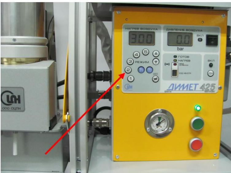
Температурный режим нагрева воздуха устанавливается кнопками на панели.
