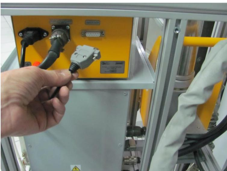
После установки необходимого расхода порошка для обеспечения возможности включения питателя от рукоятки напылителя или дистанционно подключите разъем «ДИСТ. УПР.».
