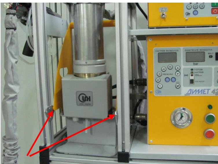
Дозирующий блок питателя следует переставить из транспортного положения ...
