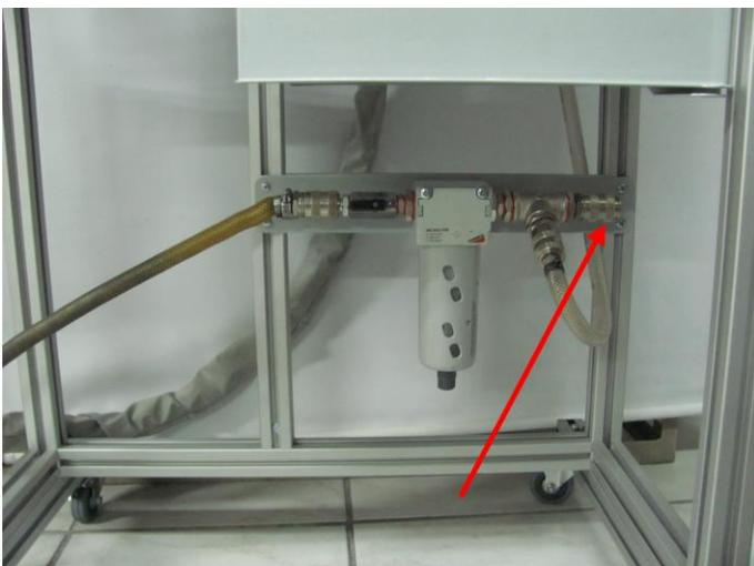
Для подключения аппарата СД-6 можно использовать пневматическую розетку на нижней части стойки.
