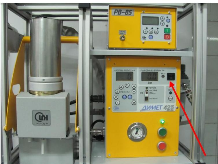
Направьте сопло напылителя в безопасную сторону и нажмите клавишу «ВКЛ» на панели.
