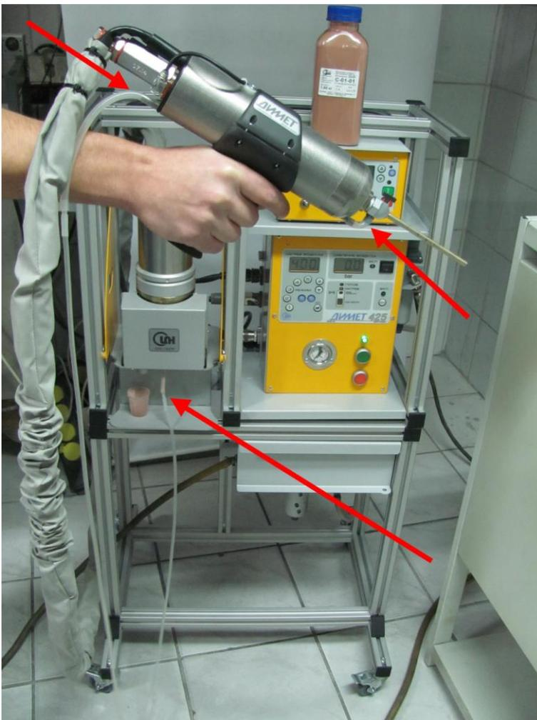
При включении подачи воздуха и подачи порошка происходит перенос порошка от питателя к напылителю и далее к штуцеру (ниппелю) сверхзвукового сопла. Через штуцер порошок инжектируется в сверхзвуковой поток и ускоряется.
