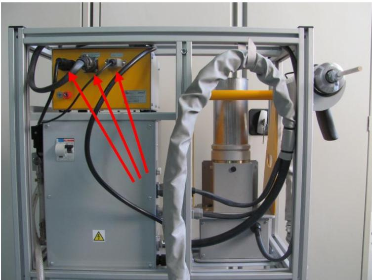
К блоку управления питателем подключаются разъёмы дистанционного управления, управления дозирующим блоком и питающей сети.
