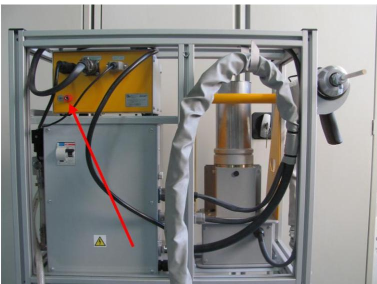
Блок управления питателем подключается к линии заземления блока управления.
