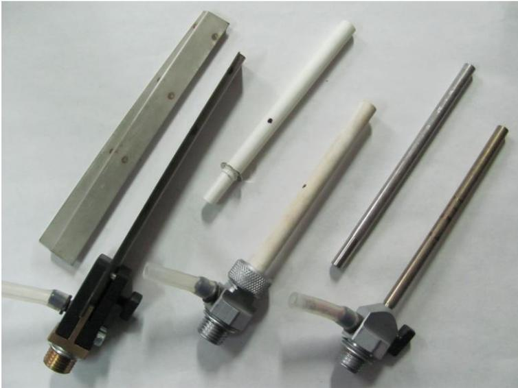
Оборудование ДИМЕТ-425 комплектуется сверхзвуковыми соплами СК20 (справа), СК30 (в центре) и СП9 (слева).
