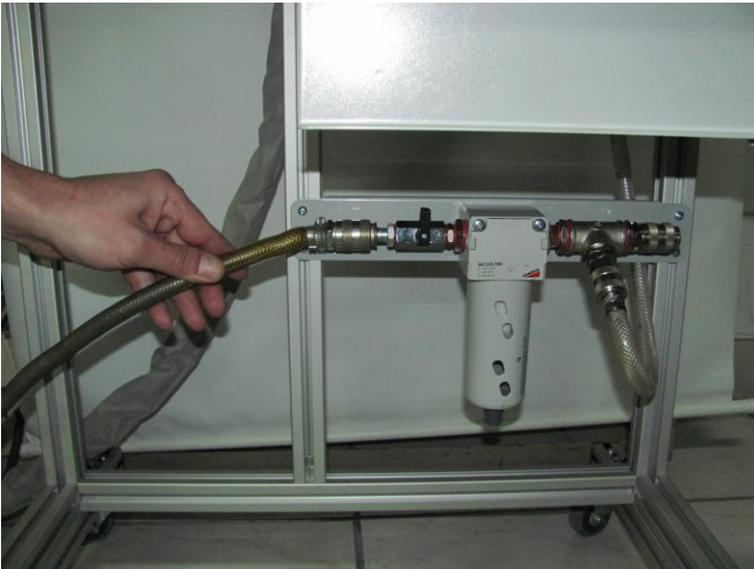
Подключение воздушной магистрали производится к входу фильтра на нижней части стойки.
