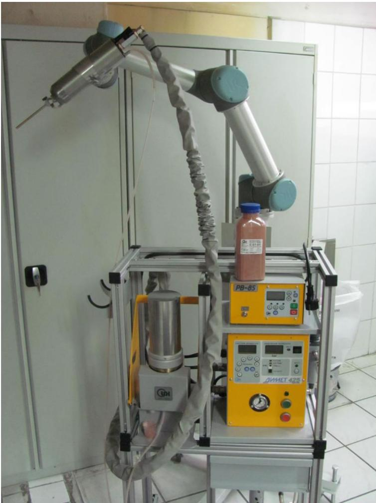
Напылитель без рукоятки может быть установлен на манипулятор.
