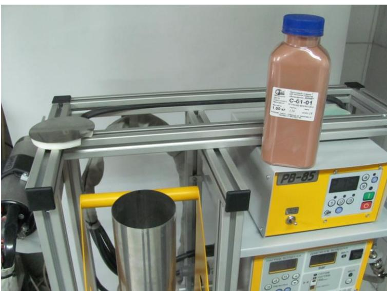
Скорость подачи порошкового материала в сверхзвуковое сопло установки ДИМЕТ-425 не должна превышать 0,4 – 0,5 граммов в секунду. Более высокая скорость подачи порошка может приводить к перегрузке сверхзвукового потока, в результате чего снижаются качество покрытия и эффективность его нанесения.
