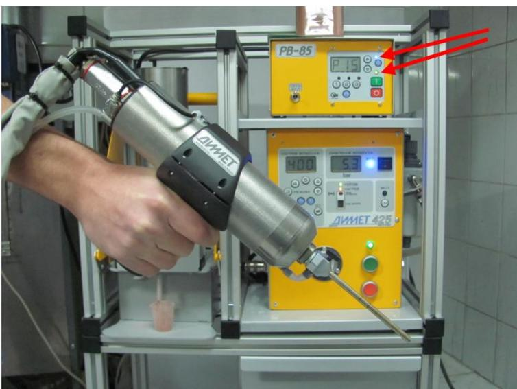
Дальнейшее нажатие клавиши включает порошковый питатель, что индицируется светодиодами на панели блока управления питателя.
