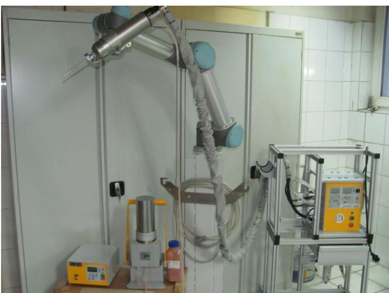
При необходимости порошковый питатель и блок управления питателем могут быть сняты со стойки и установлены в ином месте, ближе к напылителю.
