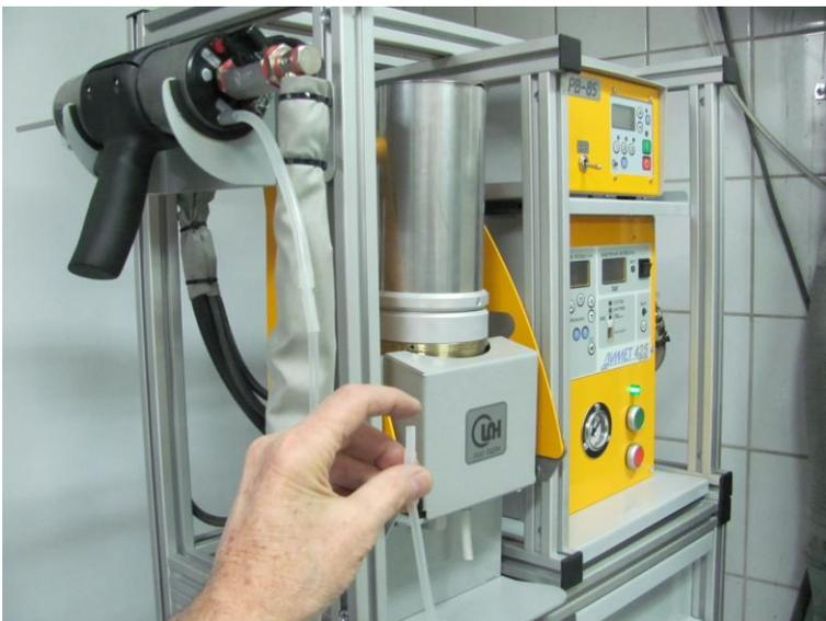
Сужения тракта подачи порошка могут приводить к образованию пробок и неравномерной подаче порошка в сопло.
