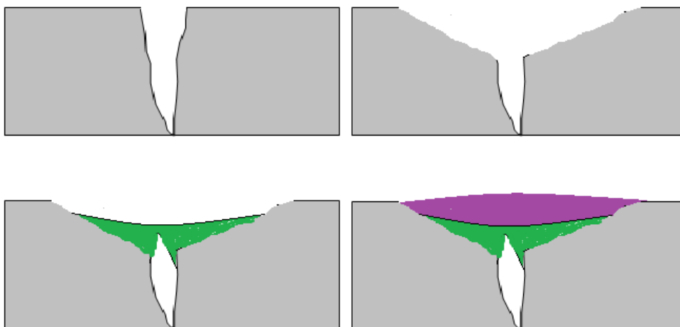
Рис. 9. Разделка, частичное устранение дефекта и блокирование покрытия.
